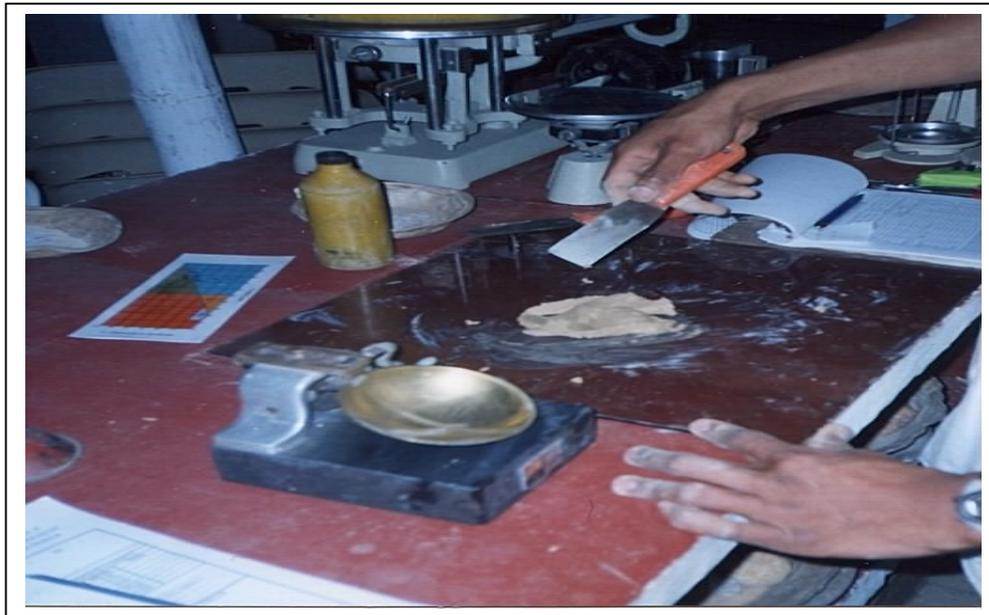
**Foto 17:** Copa de Casagrande utilizada para la determinación de los límites de consistencia de las muestras obtenidas en campo.
