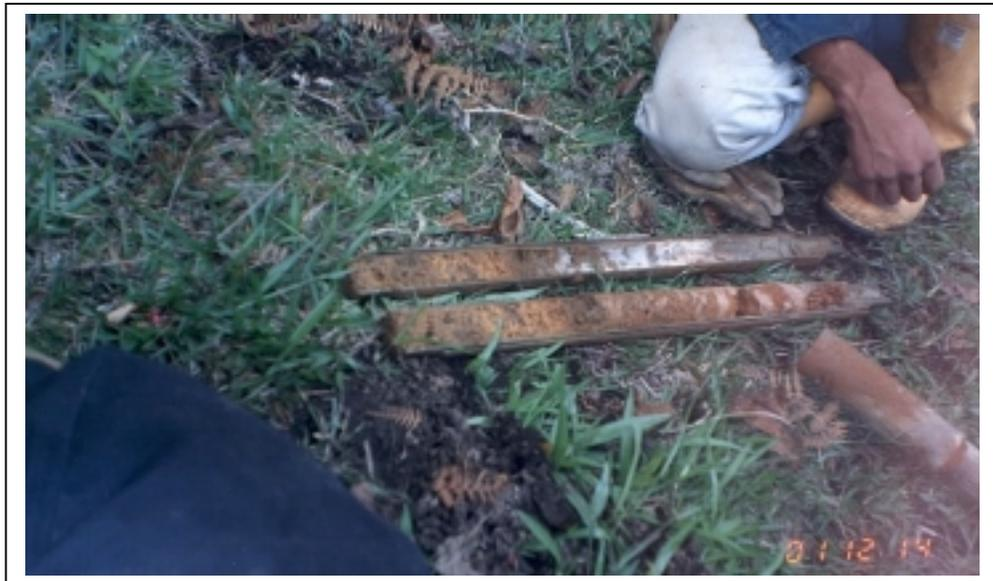
**Foto 12:** Muestra de suelo obtenida con tubo ranurado en el sitio de prueba No. 3.
